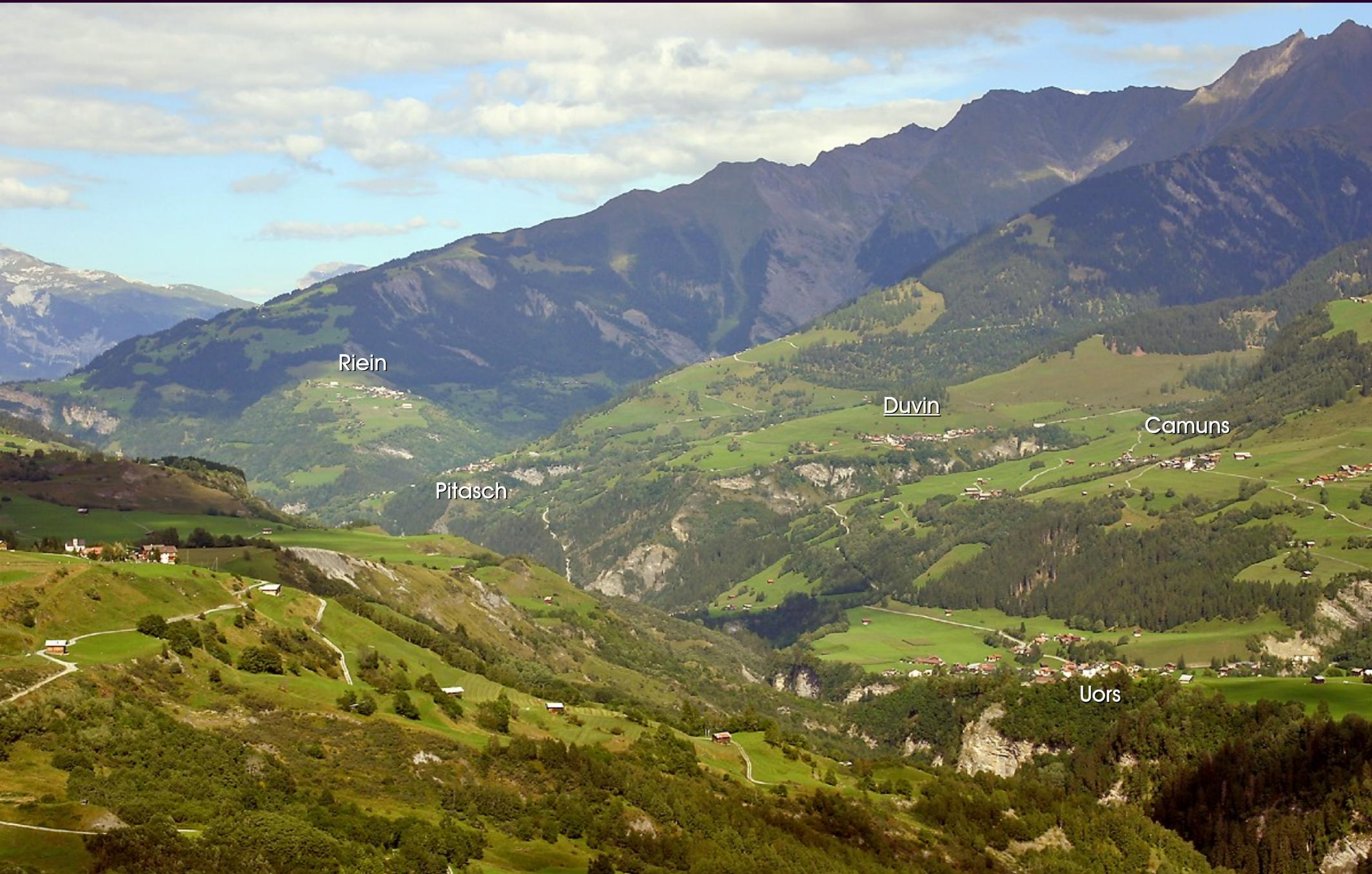
Fast alle Dörfer der linken Talseite sind durch eine Längsstrasse miteinander verbunden. Ganz anders ist es bei den Dörfern der rechten Talseite. Zwischen ihnen liegen unüberbrückbare Schluchten, so dass für jedes Dorf eine eigene Strasse von der Talstrasse aus gebaut werden musste. Solche Strassen nennt man Stichstrassen. Auf der Schulkarte sieht man dies am Beispiel von Duvin.
