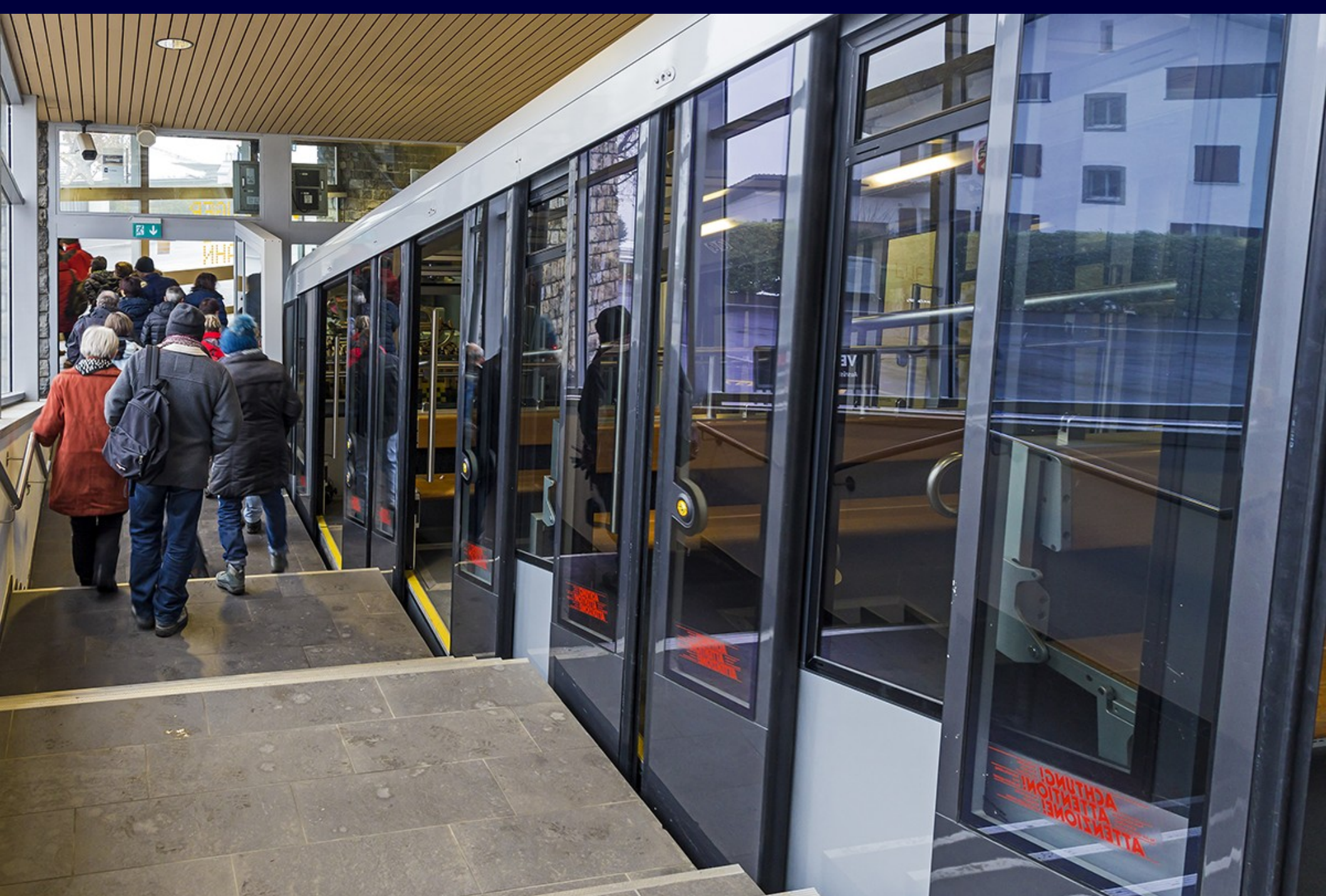
So sieht die erneuerte Zugerbergbahn im Jahr 2013 aus. Die Geländer sind entfernt, im untersten Abteil können Rollstühle und Kinderwagen hindernisfrei eingefahren werden. Die Bahn fährt tagsüber alle 30 Minuten.
